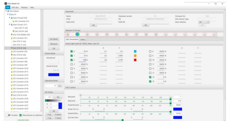
Rysunek 8 Konfiguracja grupy DALI dla urządzenia DT8 XY
